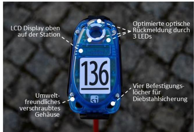
Um die BSF9-Station gegen Diebstahl zu sichern, hat das neue Gehäuse vier Befestigungslöcher, mit denen die Station gesichert werden kann. Das passende 2m lange, ummantelte Stahlseil mit Sicherheitsschloss kannst du ebenfalls direkt bei uns bekommen.
